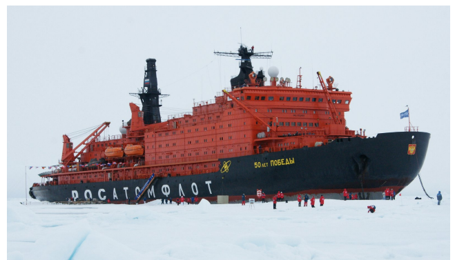
FIGURE 9.28 – Le 50 Let Podyby, brise-glace de 25 000 t à propulsion nucléo-turbo-électrique (deux réacteurs de 171 MW chaleur , trois moteurs de 17,6 MW méch. ). Sa construction a débuté en 1989 mais il n'est entré en service qu'en 2007.
