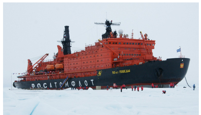
FIGURE 9.28 – Le 50 Let Podeby, brise-glace de 25 000 t à propulsion nucléo-turbo-électrique (deux réacteurs de 171 MW chaleur , trois moteurs de 17,6 MW méch. ). Sa construction a débuté en 1989 mais il n'est entré en service qu'en 2007.
