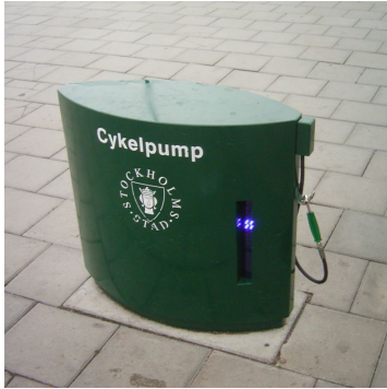
FIGURE 8.15 – Compresseur à air à usage public à Stockholm, destiné aux cyclistes. Un échangeur de chaleur intégré sous la carrosserie permet heureusement d'éviter les températures calculées dans cet exercice.
