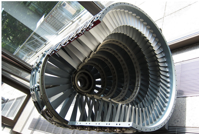
FIGURE 10.8 – Caisson de stators accueillant le rotor d’un compresseur axial d’un turboréacteur.
