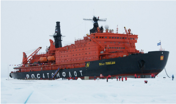
FIGURE 9.28 – Le 50 Let Pobedy , brise-glace de 25 000 t à propulsion nucléo-turbo-électrique (deux réacteurs de 171 \text{ MW}_{\text{chaleur}} , trois moteurs de 17,6 \text{ MW}_{\text{méca.}} ). Sa construction a débuté en 1989 mais il n'est entré en service qu'en 2007.
