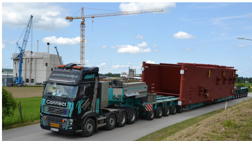
FIGURE 9.3 – Transport d'une chaudière de centrale à bois capable de soutenir une pression de 100 bar.
