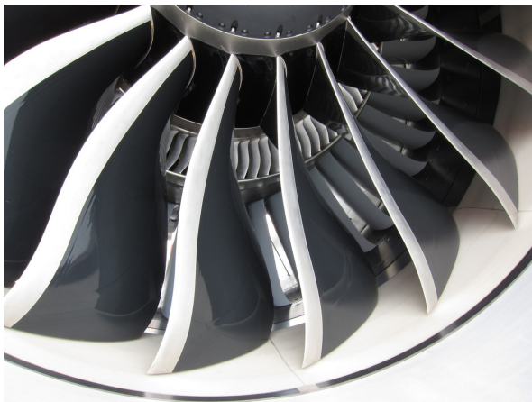
FIGURE 4.17 – Entrée d'air d'un des quatre turboréacteurs General Electric GENx-2B équipant un Boeing 747-8. Les pales bicolores de la soufflante sont visibles au premier plan ; derrière, le flux d'air est divisé entre l'entrée du compresseur (intérieur) et les stators redresseurs du flux froid (extérieur).
