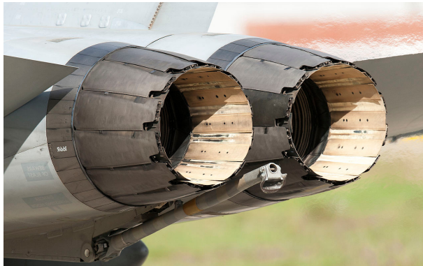
FIGURE 10.14 – Les tuyères de deux General Electric F404 équipant un avion de combat. La géométrie de la tuyère (qui n'est pas abordée dans ce livre) est programmée pour s'adapter au débit massique du moteur et à l'utilisation éventuelle de la postcombustion.
