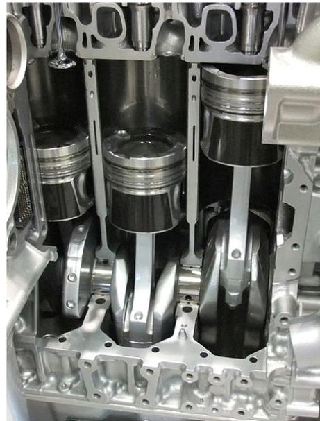
FIGURE 2.21 – Pistons et cylindres d'un moteur automobile découpé.
