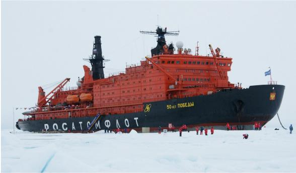
FIGURE 9.28 – Le 50 Let Poddeby, brise-glace de 25 000 t à propulsion nucléo-turbo-électrique (deux réacteurs de  $171 \text{ MW}_{\text{chaleur}}$ , trois moteurs de  $17,6 \text{ MW}_{\text{méca.}}$ ). Sa construction a débuté en 1989 mais il n'est entré en service qu'en 2007.
