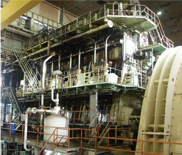
FIGURE 7.16 – Un moteur Diesel *Sulzer RTA76* à neuf cylindres dégageant 25 MW de puissance à 95 rpm. Cet exemplaire est installé ici dans une usine mais le modèle est couramment utilisé pour propulser des navires marchands.
