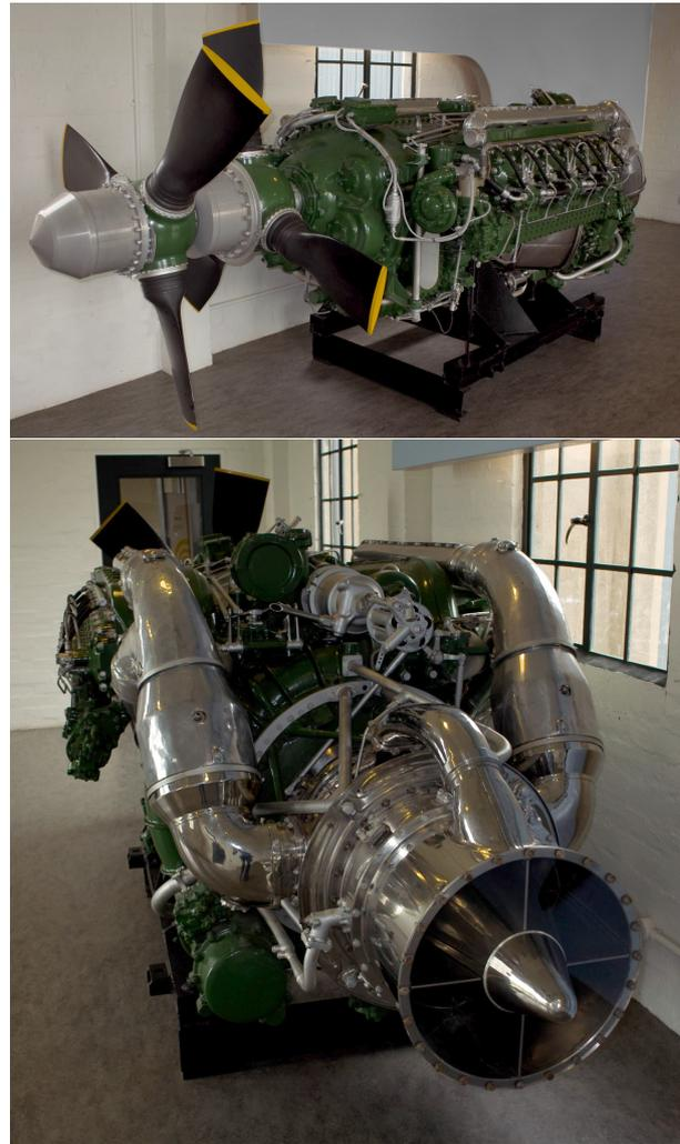
FIGURE 10.28 – Le prototype du *Napier Nomad I*. La cylindrée est de 40 L et le poids dépasse 2 tonnes.
