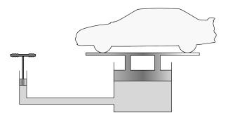
FIGURE 1.11 – Schéma de principe d'un cric hydraulique. Schéma CC-0 Olivier Cleynen
