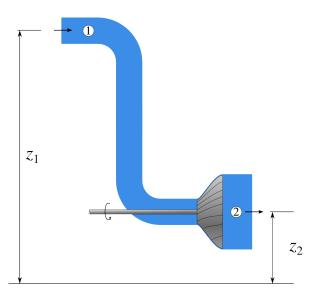
FIGURE 1.12 – Schéma de principe d'une turbine à eau. L'eau pénètre en haut à gauche, fait tourner les pales de la turbine, est réchauffée par frottement, et ressort en bas à droite de l'installation.
