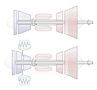
FIGURE 10.38 – En haut : schéma de principe d'un turbomoteur basé sur le CF6 dont on a supprimé la soufflante.
