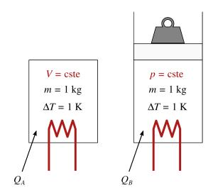
FIGURE 4.3 – Définitions des capacités thermiques. À gauche, le volume est fixé et la capacité thermique sera  $c_v$ . À droite, la pression est constante et la capacité sera  $c_p$ . Schéma CC-0 Olivier Cleynen
