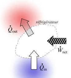
FIGURE 6.12 – Transferts énergétiques associés à un réfrigérateur ou à un climatiseur. On souhaite obtenir un grand transfert  $\dot{Q}_{\rm in}$  (résultat) à partir du transfert  $\dot{W}_{\rm net}$  (coût).
