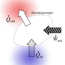
FIGURE 6.13 – Transferts énergétiques associés à une pompe à chaleur. On souhaite obtenir un grand transfert  $\dot{Q}_{\rm out}$  (résultat) à partir du transfert  $\dot{W}_{\rm net}$  (coût).
