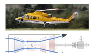
FIGURE 1.14 – Un hélicoptère Sikorsky S-76B, équipé de deux turbomoteurs *P&WC* PT-6B de 980 ch chacun. Le trajet de l'air dans les moteurs est représenté dans un schéma de principe. Nous étudions ces moteurs plus en détail au chapitre 10 (*cycles moteur à air*).
