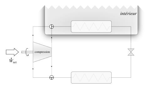
Figure 6.10 – Agencement d'un climatiseur inversable (dit « réversible » dans l'usage). En pivotant des deux vannes de  $90^\circ$  dans le sens anti-horaire, on change la fonction depuis une pompe à chaleur vers un climatiseur.
