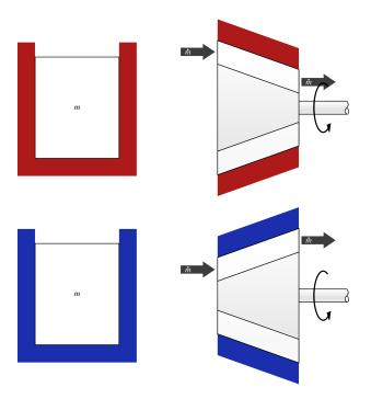
FIGURE 4.8 – Évolution à volume constant (isochore) d'un gaz parfait. En système fermé (à gauche), le volume est bloqué et aucun travail n'est effectué. En système ouvert (à droite), on doit comprimer le gaz pendant qu'on le chauffe et le détendre pendant qu'on le refroidit, pour pouvoir maintenir le volume massique constant.
