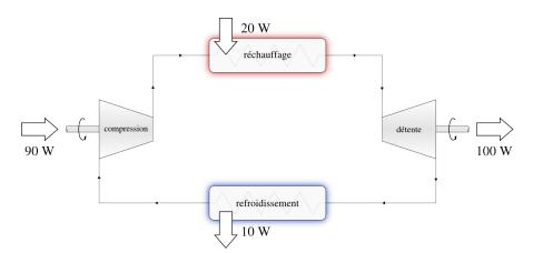
FIGURE 10.1 – Le cycle d'un moteur (hypothétique) à faible marge de travail. La puissance développée est de  $\dot{W}_{\rm net} = \dot{W}_{\rm compression} + \dot{W}_{\rm détente} = +90 + (-100) = -10 \, {\rm W},$  et le rendement  $\eta_{\rm moteur} = -\frac{\dot{W}_{\rm net}}{\dot{Q}_{\rm in}} = -\frac{-10}{20} = 50 \, \%.$
