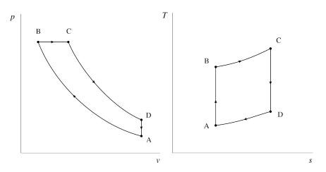
FIGURE 10.4 – Cycle théorique de Diesel représenté sur des diagrammes pressionvolume et température-entropie. Ces graphiques représentent le trajet idéal, sans irréversibilité de compression ou détente. Diagrammes CC-0 Olivier Cleynen
