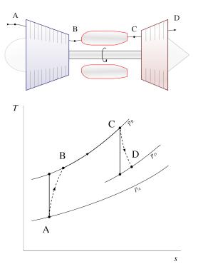
Figure 10.16 – Cœur de turbomachine, ou « générateur à gaz ». Cette configuration n'a pas d'intérêt en elle-même mais a de nombreuses applications dérivées. L'une d'elles est le *turbo*, pour lequel un moteur à pistons fait office de chambre de combustion (§10.3.5).
