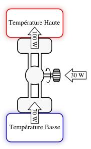
$\label{thm:figure 7.5-Unexample de transferts énergétiques en jeu dans un réfrigérateur, un climatiseur ou une pompe à chaleur en fonctionnement.$
