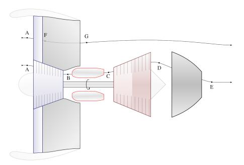
FIGURE 10.19 – Schéma de principe d'un turbofan. Le circuit central du moteur  $(A \to E)$  alimente mécaniquement la soufflante, qui permet au circuit externe  $(A \to G)$  de fournir la majorité de la poussée.
