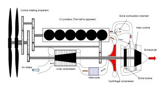
FIGURE 10.27 – Schéma de principe du circuit thermodynamique du *Napier Nomad I*. L'arbre de la turbomachine et celui du Diesel alimentent chacun une hélice. Pourtant, les deux ensembles sont montés en série : l'air circule d'abord dans les compresseurs, puis dans les cylindres, puis dans la ou les turbines. La puissance du moteur, comme c'est l'usage en 1950, est contrôlée avec une seule manette de commande mécanique!
