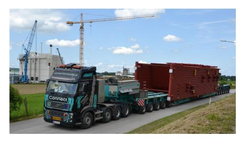
FIGURE 9.3 – Transport d'une chaudière de centrale à bois capable de soutenir une pression de 100 bar.
