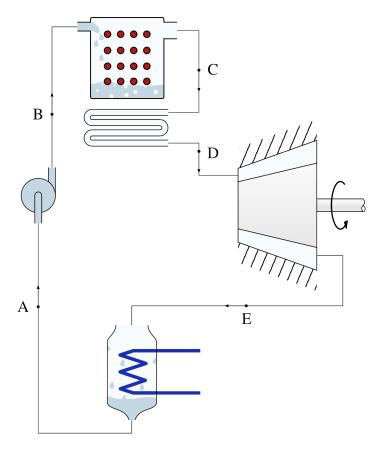
FIGURE 9.14 – Circuit d'une centrale à vapeur fonctionnant sur un cycle de Rankine surchauffé. L'eau à la sortie de la chaudière est portée à plus haute température (section  $C \to D$ ) avant de pénétrer dans la turbine.
