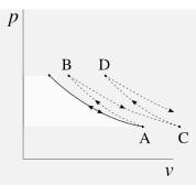
Ainsi, les propriétés se décalent progressivement sur le diagramme pression-volume. Si les évolutions ne se font pas lentement, le compresseur demande plus d'énergie que la turbine est capable de prélever au retour. Cet excédent d'énergie est absorbé par l'air, ce qui augmente son énergie interne et sa température.
