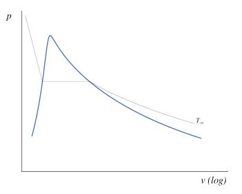
FIGURE 5.9 – Diagramme pression-volume de l'eau, représenté avec une évolution à température constante (isotherme). La courbe de saturation est représentée en bleu.
