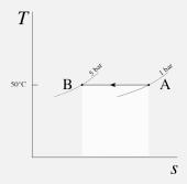
Pour quantifier  $\Delta S$  nous partons de l'équation 8/11,  $\Delta s = c_p \ln \frac{T_B}{T_A} - R \ln \frac{p_B}{p_A}$  et ici  $T_B = T_A$ . Nous avons donc  $\Delta s = -R \ln \frac{p_B}{p_A} = 287 \ln \frac{5}{1} = -461.9 \, \mathrm{J \, K^{-1} \, kg^{-1}}$ .
