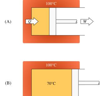
FIGURE 7.1 – Production d'un travail avec de la chaleur issue d'un corps à 100 °C. Le transfert de chaleur permet la production d'un travail, mais il provoque également une augmentation de température du fluide.
