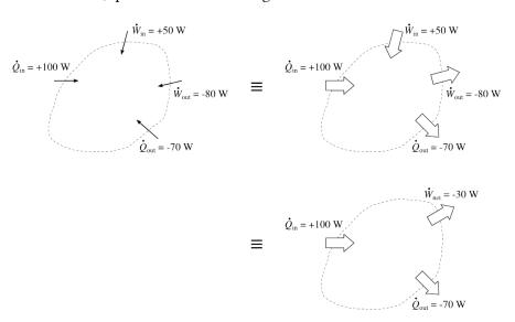
FIGURE 6.1 – Nouvelles conventions graphiques et de notation des transferts énergétiques. Les flèches blanches sont orientées selon le sens physique des transferts ; La somme algébrique de tous les travaux est représentée par un unique transfert nommé *travail net*.
