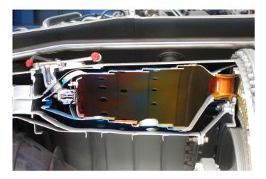
FIGURE 10.10 – Section d'une chambre de combustion annulaire dans laquelle l'écoulement se faisait de gauche à droite. La photo montre une découpe d'un *Rolls-Royce Turboméca Adour*, petit turboréacteur conçu en 1968.
