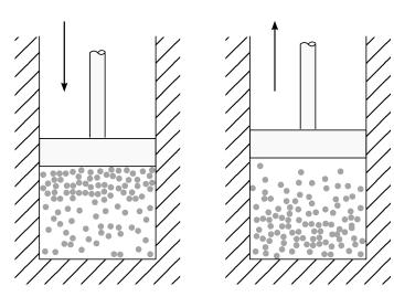
FIGURE 2.11 – Compression et détente irréversibles. Lorsqu'on comprime un fluide de façon brutale (à gauche), la pression sur la paroi du piston est augmentée. Lors d'une détente brutale (à droite) cette pression est diminuée.
