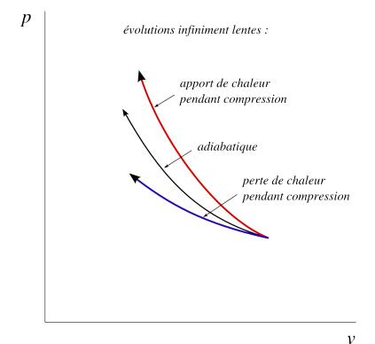
FIGURE 2.10 – Comportement d'un fluide lorsqu'on le comprime infiniment lentement. Plus on lui apporte de chaleur pendant la compression, plus la pression augmente fortement. La courbe adiabatique représente le cas où aucun apport ni perte de chaleur n'a lieu (Q=0).
