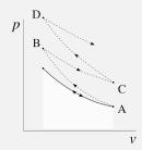
Ainsi, la pression s'élève progressivement sur le diagramme pressionvolume : l'excédent de travail investi pendant les compressions, et le défaut de travail récupéré pendant la détente, se traduisent par une augmentation de l'énergie interne du gaz, dont la température augmente continuellement.
