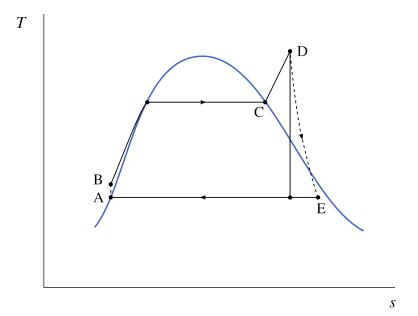
$\label{eq:figure 9.15} \mbox{-} \mbox{Diagramme temp\'erature-entropie d'une centrale à vapeur fonctionnant sur un cycle de Rankine surchauff\'e.}$
