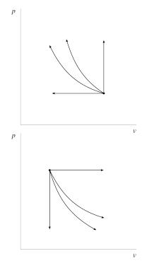
Figure 4.16 – Évolutions élémentaires d'un gaz parfait Schéma CC-0 Olivier Cleynen
