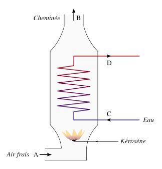
FIGURE 1.13 – Schéma de principe d'une chaudière utilisée pour le chauffage d'un bâtiment. L'eau (C  $\rightarrow$  D) y pénètre par la droite, et y est réchauffée par l'air (A  $\rightarrow$  B) mélangé au kérosène.
