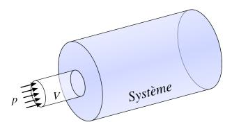
FIGURE 3.2 – Un élément de fluide de volume  $V_{\rm élément}$  pénétrant à la pression p dans le système ouvert.
