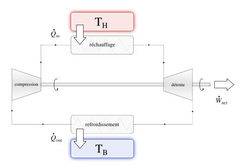
FIGURE 6.4 – Cycle thermodynamique moteur, pour lequel le compresseur et la turbine sont couplés mécaniquement. Comme la turbine fournit une puissance  $\dot{W}_{\rm out}$  supérieure à celle consommée par le compresseur ( $\dot{W}_{\rm in}$ ), elle est capable non seulement de l'entraı̂ner mais aussi de fournir un excédent  $\dot{W}_{\rm net}$  vers l'extérieur.
