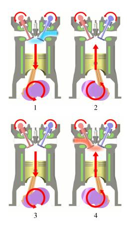
FIGURE 6.14 – Les quatre étapes d'un moteur à quatre temps. Le piston descend pour admettre de l'air frais arrivant de la droite (admission, 1); il monte ensuite pour augmenter la température de l'air (compression, 2); la production de travail utile a lieu pendant une descente (détente, 3); enfin l'air est rejeté à l'extérieur lors d'un quatrième et dernier mouvement (échappement), 4) avant de recommencer le cycle. La plupart des moteurs à pistons-cylindres actuels suivent ce procédé.
