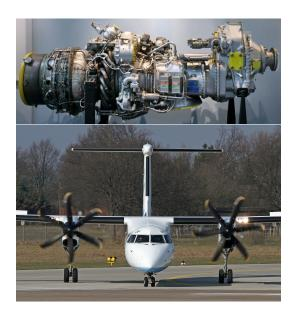
FIGURE 10.34 – Un turbopropulseur *Pratt & Whitney Canada* Pwc123 équipant un *Bombardier* Dash 8. Le Pwc123 est configuré avec trois ensembles tournants concentriques, dont l'arbre moteur alimenté par un turbine libre, mais son agencement de principe reste similaire à celui décrit en figure 10.33.
