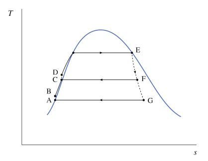
$\label{eq:figure 9.21} \mbox{-} \mbox{Diagramme temp\'erature-entropie d'une centrale avec pr\'elèvement de vapeur.}$
