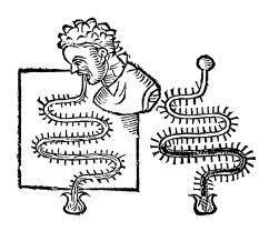
FIGURE 1.6 – Thermomètre médical du début du XVII<sup>e</sup> siècle. La boule de gaz était mise en bouche par le patient. On se doute que la sensibilité du thermomètre à la pression atmosphérique n'était pas le plus gros obstacle à son adoption...
