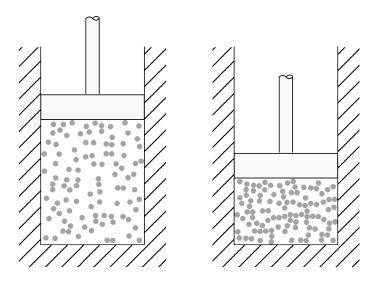
Figure 2.7 – Une représentation simpliste d'un fluide que l'on comprime infiniment lentement sans le chauffer. Le fluide voit sa température et sa pression augmenter. Schéma CC-0 Olivier Cleynen
