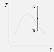
Ici  $q_{A\to B} = 0$  car la turbine est adiabatique, et nous cherchons  $w_{A\to B} = \Delta h$ . Il nous faut donc trouver un moyen de quantifier  $h_B$ .
