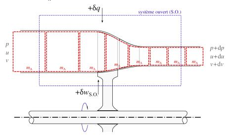
FIGURE 3.5 – Le même écoulement qu'en figure 3.4 observé du point de vue d'un système ouvert immobile traversé de gauche à droite par un flux continu. Nous cherchons à quantifier le travail  $\delta w_{\rm S.O.}$  à fournir au système pour que chaque quantité de masse  $m_{\rm A}$  reçoive un travail  $\delta w_{m_{\rm A}}$ .
