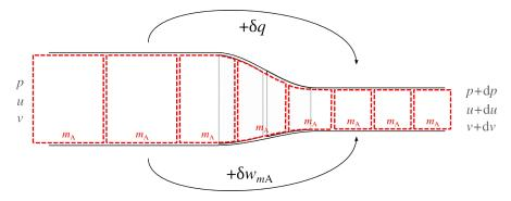
FIGURE 3.4 – Une quantité de masse fixe  $m_{\rm A}$  circule de gauche à droite à travers un compresseur. Elle est comprimée : ses propriétés passent de p et v à  $p+{\rm d}p$  et  $v+{\rm d}v$ . Si on se place du point de vue d'un système fermé en transit, le transfert de travail est  $\delta w_{m_{\rm A}} = -p {\rm d}v$ .
