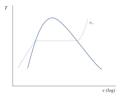
FIGURE 5.7 – Diagramme température-volume de l'eau, représenté avec une évolution à pression constante (isobare). La courbe de saturation est représentée en bleu.
