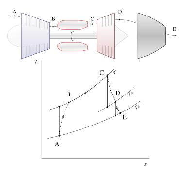
FIGURE 10.17 – Turboréacteur (schéma de principe et diagramme température-entropie). À la sortie de la turbine, l'air est encore pressurisé; il est détendu dans une tuyère.
