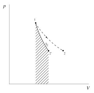
FIGURE 8.2 - Évolution du volume lors de détentes adiabatiques. L'augmentation du volume est calculable par l'intégration  $\int \delta W/p$  le long d'un parcours réversible  $(1 \rightarrow 2')$ , mais pas le long d'un parcours irréversible  $(1 \rightarrow 2)$ .
