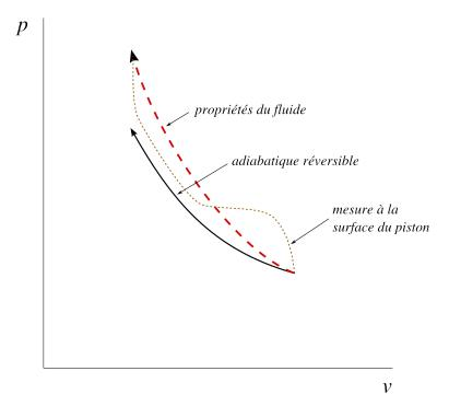
FIGURE 2.14 – Compression irréversible adiabatique sur un diagramme pression-volume.
