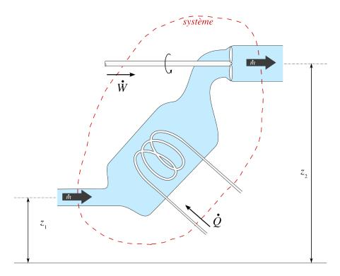
FIGURE 3.3 – Système ouvert arbitraire. Le système (dont les frontières sont en pointillés, en rouge) est traversé de gauche à droite par le fluide qui circule avec un débit de masse  $\dot{m}$  constant. Il reçoit une puissance  $\dot{W}_{1\rightarrow 2}$  sous forme de travail et une puissance  $\dot{Q}_{1\rightarrow 2}$  sous forme de chaleur.
