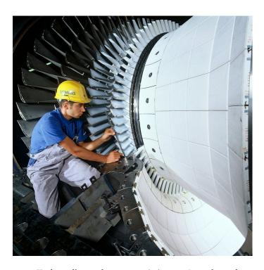
FIGURE 10.12 – Turbine d'un turbomoteur générateur. La turbine photographiée, une Siemens SGT5, peut accepter un débit d'air et d'eau de 690 kg s $^{-1}$ . Elle transmet une puissance à l'arbre d'environ 500 MW.
