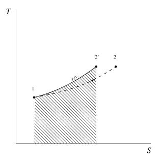
FIGURE 8.3 - Diagramme température-entropie. Lors d'une transformation réversible, l'aire sous la courbe d'un diagramme T - S représente la chaleur transmise  $Q_{1\rightarrow 2'}$ ; mais pas lorsqu'elle est irréversible. Diagramme CC-0 Olivier Cleynen
