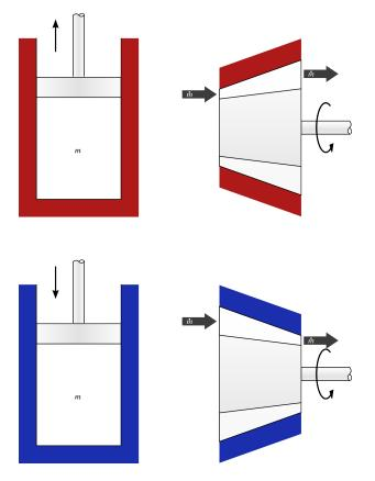
FIGURE 4.10 – Évolution à température constante (isotherme) d'un gaz parfait. En système fermé (à gauche), on laisse travailler le gaz sur un piston pendant qu'on le chauffe, et à l'inverse, on lui fournit du travail lorsqu'on le refroidit. En système ouvert (à droite), les mêmes manipulations sont effectuées en flux continu.
