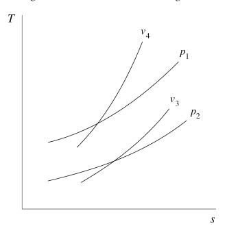
FIGURE 8.7 – Courbes isobares et isochores sur un diagramme T-s, pour un gaz parfait. Ici  $p_1>p_2$  et  $v_3>v_4$ .
