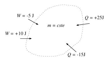
FIGURE 2.4 – Conventions de signe pour un système fermé. Les flux entrants sont positifs, les flux sortants sont négatifs; ils sont tous représentés avec des flèches rentrantes. La quantité de masse est fixe.
