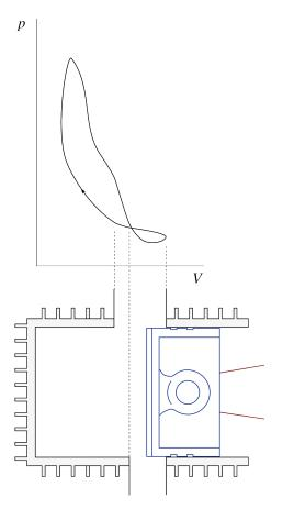
FIGURE 6.16 – Diagramme pression-volume schématique du cylindre d'un moteur deux-temps à admission carter. Il est laissé à l'étudiant/e le loisir de retrouver laquelle des deux lumières (haute ou basse) correspond à l'admission et à l'échappement dans le cylindre.
