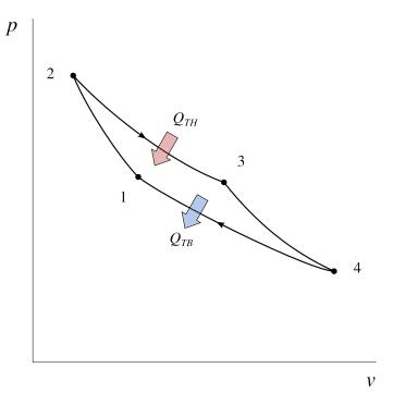
FIGURE 7.10 – Diagramme pression-volume du moteur de Carnot réalisé avec un gaz parfait. Les évolutions  $2 \rightarrow 3$  et  $4 \rightarrow 1$  se font respectivement à  $T_H$  et  $T_B$ .
