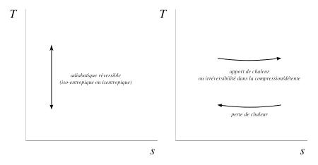
FIGURE 8.4 – Évolutions élémentaires sur les diagrammes température-entropie.
