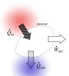
FIGURE 6.11 – Transferts énergétiques associés à un moteur. On souhaite obtenir un grand transfert  $\dot{W}_{\rm net}$  (résultat) à partir du transfert  $\dot{Q}_{\rm in}$  (coût). Le rejet  $\dot{Q}_{\rm out}$  est indésirable.
