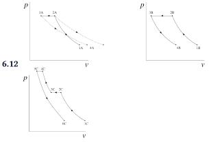
1) Si le circuit RAM est fermé, alors  $T_{3A} = T_{2A}$ ; et puisque  $T_{4A} = T_{3A}$  (§4.3.2) on obtient  $T_{4A} = T_{1A} \left( \frac{p_{2B}}{p_{1B}} \right)^{\frac{\gamma-1}{\gamma}} = 377,19 \text{ K} = 104,1 \,^{\circ}\text{C}.$
