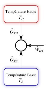
FIGURE 7.3 – Une machine thermique transformant travail et chaleur dans sa représentation la plus générale. Schéma CC-0 Olivier Cleynen
