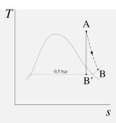
Le calcul du titre (§5.3.3) nous permet de calculer la valeur de son enthalpie :  $h_{\rm B'} = h_{L0,05\,{\rm MPa}} + \frac{s_{\rm B'} - s_{L0,05\,{\rm MPa}}}{s_{LV0,05\,{\rm MPa}}} h_{LV0,05\,{\rm MPa}} = 2566,3\,{\rm kJ\,kg^{-1}}.$
