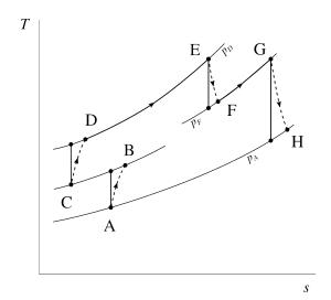
FIGURE 10.22 – Turbomoteur générateur avec refroidisseur et réchauffe (schéma de principe et diagramme température-entropie)
