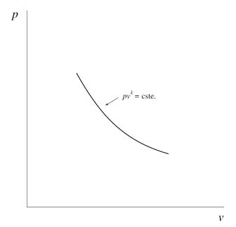
FIGURE 2.9 – Propriétés d'un gaz lorsqu'on le comprime, représentées sur un diagramme pression-volume. La relation est similaire à celle que l'on obtiendrait avec un ressort à spires progressives.
