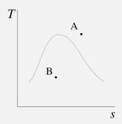
Nous lisons  $s_A$  par interpolation dans l'abaque n°1 à 0,6 MPa entre 200 °C et 300 °C :  $s_A = 6,9683 + \frac{40}{100} \times (7,374 - 6,9683) = 7,1306 \, \text{kJ K}^{-1} \, \text{kg}^{-1}$ .
