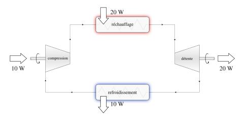
FIGURE 10.2 – Le cycle d'un second moteur (hypothétique), à forte marge de travail. La puissance développée  $\dot{W}_{\rm net} = +10 + (-20) = -10 \, {\rm W}$ , et le rendement  $\eta_{\rm moteur} = -\frac{-10}{20} = 50 \, \%$  sont identiques à celles du moteur décrit en figure 10.1.
