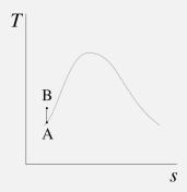
Dans l'abaque n°3 à 0,05 MPa nous lisons l'enthalpie d'entrée  $h_{\rm A}=h_{L0,05\,{\rm MPa}}=340,5\,{\rm kJ\,kg^{-1}}.$  Le volume massique restera presque constant dans la pompe, à sa valeur de  $v_{\rm A}=v_{L0,05\,{\rm MPa}}=0,001\,03\,{\rm m^3\,kg^{-1}}.$
