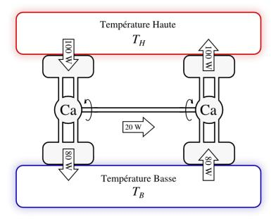
FIGURE 7.6 – Deux machines de Carnot, un moteur (à gauche) et un réfrigérateur (à droite). La première alimente la seconde, et comme elles sont réversibles (au sens thermodynamique du terme), les flux de chaleur sont compensés.
