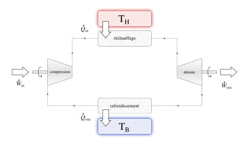
FIGURE 6.2 – Cycle thermodynamique moteur. Le fluide absorbe de la chaleur fournie à haute température  $T_H$ . la puissance de compression est plus faible que la puissance à la détente : la puissance nette sous forme de travail  $\dot{W}_{\rm net} = \dot{W}_{\rm in} + \dot{W}_{\rm out}$  est négative.
