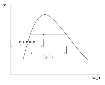
FIGURE 5.13 – Approximations utilisées dans le calcul du volume occupé par un mélange liquide-vapeur. Il faut bien noter que l'échelle en abscisse est logarithmique :  $v_L$  est en général plusieurs centaines de fois plus petit que  $v_V$ , et l'approximation n'est pas mise en valeur graphiquement.
