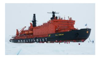
FIGURE 9.28 – Le 50 Let Podeby, brise-glace de  $25\,000\,\mathrm{t}$  à propulsion nucléo-turbo-électrique (deux réacteurs de  $171\,\mathrm{MW_{chaleur}}$ , trois moteurs de  $17,6\,\mathrm{MW_{méca.}}$ ). Sa construction a débuté en 1989 mais il n'est entré en service qu'en 2007.
