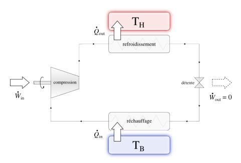
FIGURE 6.7 – Cycle de réfrigération modifié. Lorsque l'on utilise des liquides/vapeurs, il est possible de se dispenser d'extraire du travail lors de la détente. L'utilisation d'une simple soupape suffit pour faire baisser la température du fluide.
