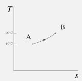
Pour calculer  $\Delta S$  nous partons de l'équation 8/11,  $\Delta s = c_p \ln \frac{T_{\rm B}}{T_{\rm A}} - R \ln \frac{p_{\rm B}}{p_{\rm A}}$  et ici  $p_{\rm B}=p_{\rm A}$ . Nous avons donc  $\Delta s=c_p \ln \frac{T_{\rm B}}{T_{\rm A}}=1005 \ln \frac{100+273,15}{10+273,15}=+277,4\,{\rm J\,K^{-1}\,kg^{-1}}.$
