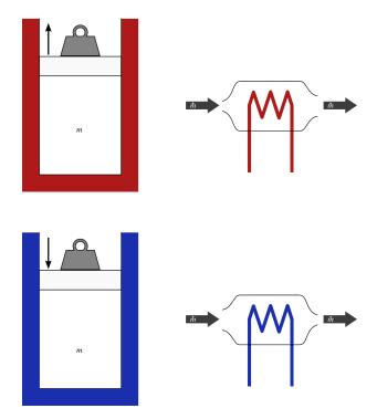
FIGURE 4.6 – Évolution à pression constante (isobare) d'un gaz parfait. En système fermé (à gauche), le piston exerce une force constante tout au long de l'évolution. En système ouvert (à droite), aucun travail n'est effectué.
