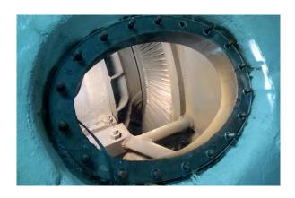
FIGURE 8.14 – Hublot d'inspection d'une des turbines basse pression (puissance ~25 MW) du porte-avions *USS Hornet* lancé en 1943.
