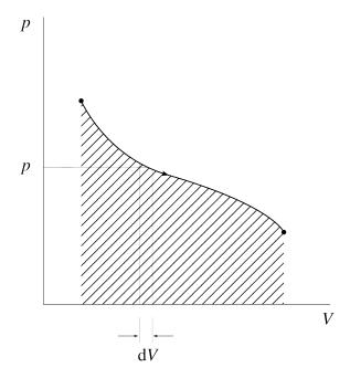
FIGURE 2.6 – Diagramme pression-volume d'un système fermé modélisé par un ressort. Dans le cas représenté, le volume augmente (le piston s'éloigne). La grandeur  $\mathrm{d}V$  sera constamment positive, et le travail sera négatif : le système perd de l'énergie au profit du piston.
