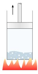
FIGURE 5.29 – Un concept très simple de moteur à vapeur Schéma CC-0 Olivier Cleynen
