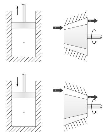
FIGURE 4.12 – Évolution adiabatique réversible (isentropique) d'un gaz parfait. En système fermé (à gauche) comme en système ouvert (à droite), l'appareil est parfaitement isolé, de sorte qu'il n'y ait aucun transfert de chaleur, même si la température du gaz varie.
