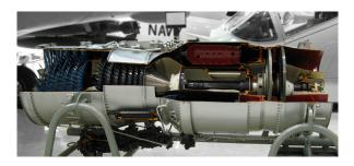
FIGURE 10.35 – Un turboréacteur à simple flux et deux arbres *Pratt & Whitney* J52 (ou JT8A), construit en 4500 exemplaires. Il équipe encore le EA-6B *Prowler*.
