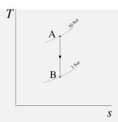
Pour quantifier  $\Delta S$  nous partons encore de l'équation  $8/11:\Delta s=c_p\ln\frac{T_{\rm B}}{T_{\rm A}}-R\ln\frac{p_{\rm B}}{p_{\rm A}}$  et ici  $\Delta s=0:$   $0=c_p\ln\frac{T_{\rm B}}{T_{\rm A}}-R\ln\frac{p_{\rm B}}{p_{\rm A}}$
