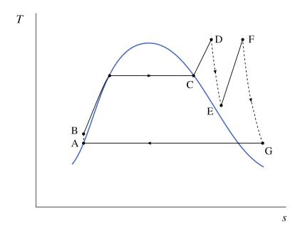
$\label{eq:figure 9.17} \mbox{-} \mbox{Diagramme température-entropie d'une centrale à vapeur fonctionnant sur un cycle de Rankine resurchauffé.}$
