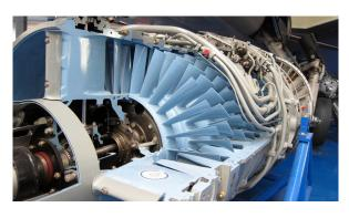
FIGURE 4.20 – Compresseur d'un turboréacteur simple flux snecma Atar (1948) découpé. L'air s'écoule depuis la gauche vers le centre de l'image.
