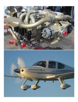
Figure 10.31 – Moteur six cylindres essence à injection Continental 10-550 de 300 ch, en fabrication depuis 1983. Il équipe entre autres l'avion Cirrus sR22.
