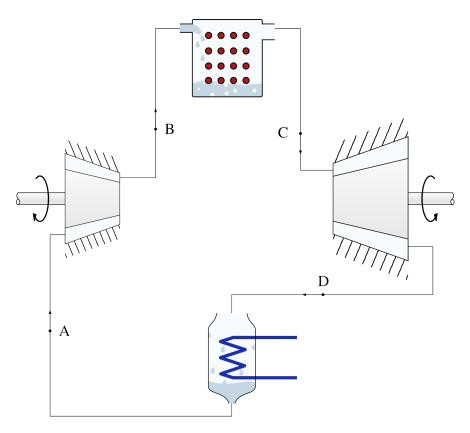
FIGURE 9.10 – Circuit d'une centrale à vapeur fonctionnant sur un cycle de Carnot. Schéma CC-BY-SA Olivier Cleynen
