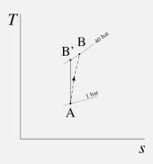
Nous commençons par calculer la puissance d'un compresseur idéal (isentropique) : la température de sortie serait alors (4/37) :  $T_{\rm B'}=T_{\rm A}\left(\frac{p_{\rm B}}{p_{\rm A}}\right)^{\frac{\gamma-1}{\gamma}}=(5+273,15)\,(40)^{\frac{0.4}{1.4}}=798\,{\rm K}=524,9\,^{\circ}{\rm C}.$  Le compresseur idéal consommerait donc  $w_{\rm compresseur}$  isentropique =  $c_{p({\rm air})}\,(T_{\rm B'}-T_{\rm A})=1005\,(798-278,15)=+5,225\times10^5\,{\rm J\,kg^{-1}}=+522,5\,{\rm kJ\,kg^{-1}}.$
