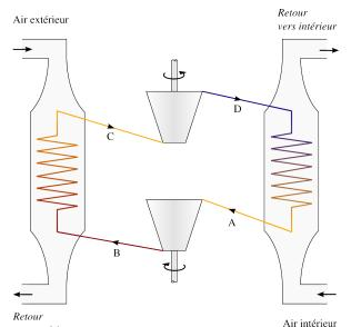
vers extérieur FIGURE 6.22 – Schéma de principe d'un climatiseur. L'air du circuit du climatiseur tourne en continu  $(A \rightarrow B \rightarrow C \rightarrow D \rightarrow A)$ , sans jamais quitter la machine.
