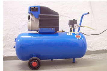
FIGURE 4.15 – Un petit compresseur électrique monté sur un réservoir d'air portatif
