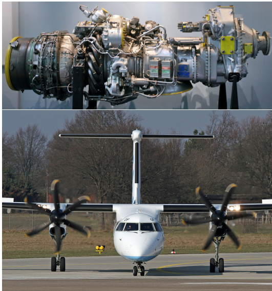
FIGURE 10.34 – Un turbopropulseur Pratt & Whitney Canada PWC123 équipant un Bombardier Dash 8 . Le PWC123 est configuré avec trois ensembles tournants concentriques, dont l'arbre moteur alimenté par un turbine libre, mais son agencement de principe reste similaire à celui décrit en figure 10.33.
