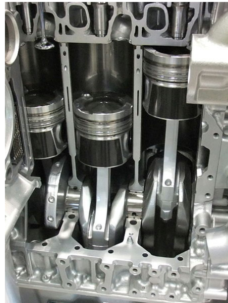
FIGURE 2.21 – Pistons et cylindres d'un moteur automobile découpé.
